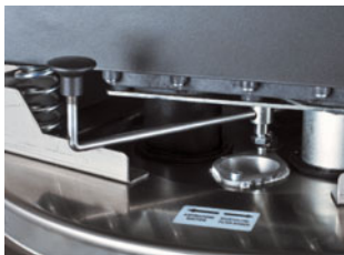
drążek nawrotnika przepływu powietrza do czyszczenia filtra
