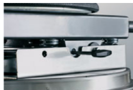
drążek nawrotnika przepływu powietrza do czyszczenia filtra
